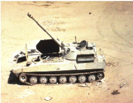
**САУ М-1974, 122-мм гаубица – Самоходная артиллерийская установка**
