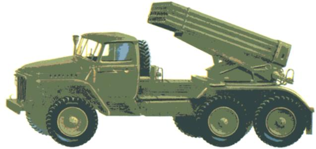
**БМ-21, 122-мм многоствольная реактивная установка, автомобиль “Урал-375Д”**
